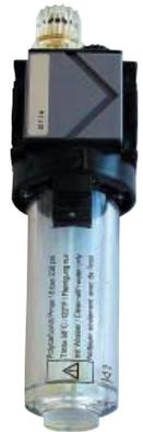
**Hinweis:** Ölbehälter aus Polycarbonat werden von Öladditiven, Antifrost- oder synthetischen Ölen angegriffen. Deswegen empfehlen wir Schmieröle mit annähernd 22 bis 32 cSt bei 40°C (im Falle von Schlagwerkzeugen bis zu 68 cSt.) und verweisen auf unser Druckluft-Spezial-Öl (Bestell-Nr.: 04-4069.010). Für andere Öle, besonders für Niedrig-Temperatur-Öle sollten Metallbehälter und Öleraufsätze aus Metall eingesetzt werden.
