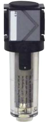
Aktivkohlefilter dienen zur Beseitigung von Öldämpfen und anderen organischen Schadstoffen aus der Druckluft. Die Aktivkohlefasern befinden sich zwischen zwei Edelstahlnetzen. Eine Reinigung ist nicht möglich (Austausch nach ca. 1000 Betriebsstunden empfohlen). Die zu reinigende Luft sollte trocken und frei von Verunreinigungen sein.
