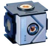
Die Variante mit Rückschlagventil ist ideal zur Entnahme ungeölter Luft, wenn sie dem Nebelöler vorgeschaltet angeflanscht wird. Durch das Rückschlagventil wird ein Ansaugen von Öl aus dem Öler oder den Leitungen verhindert. Allerdings lässt sich die Anlage nach dem Rückschlagventil nicht mehr ohne weiteres entlüften.
