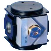
Anfahrventile dienen zum allmählichen Druckaufbau, z.B. beim Wiederauffahren nach Not-Aus. Beim Einschalten wird über eine einstellbare Drossel zuerst nur ein kleiner Querschnitt beaufschlagt. Erst wenn der Druck etwa die Hälfte des Betriebsdruckes erreicht hat, wird der volle Querschnitt freigegeben.
