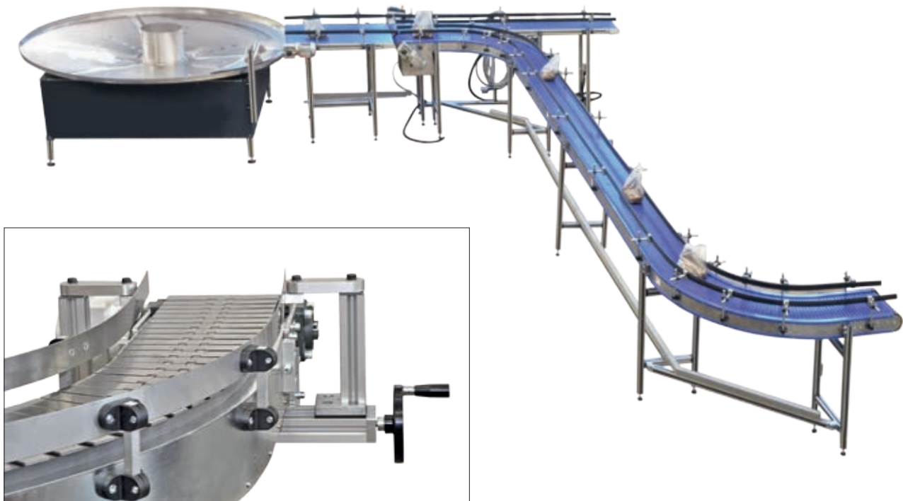
Kurvengängiger Stahlscharnierkettenförderer mit mechanisch synchron verstellbaren Seitenführungen
